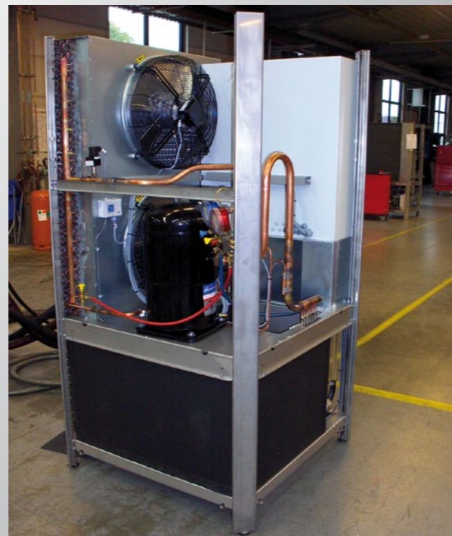
Kältemaschine in der Abschlussprüfung vor der Endmontage. Agregat chłodniczy na etapie kontroli końcowej przed ostatecznym zmontowaniem.
