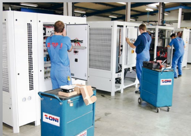
Luftgekühlte Kompakt-Kältemaschine in der Endmontage. Chłodzony powietrzem, kompaktowy agregat chłodniczy w końcowej fazie montażu.
